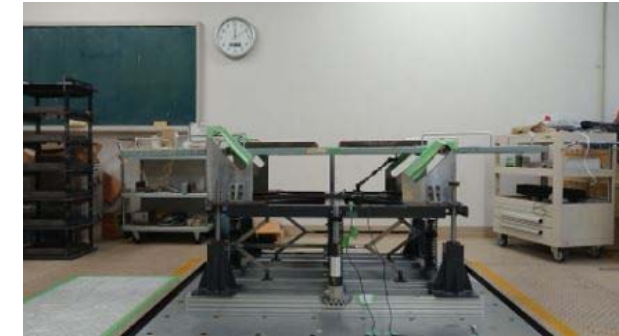
地震波再現装置(加振台)における加振実験
